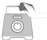
Separare capsula interna, coperchio esterno, complesso di lama e anello di tenuta. lavarli con detersivo in acqua calda, e poi sciacquare con acqua corrente e asciugarli (Figura 11). Si prega di reinstallare prima di utilizzarli.
